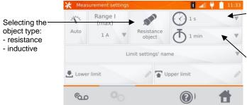
Selecting the time interval: 1 s, 5 s, 10 s, 15 s, 1 min, 5 min, 10 min, 15 min
